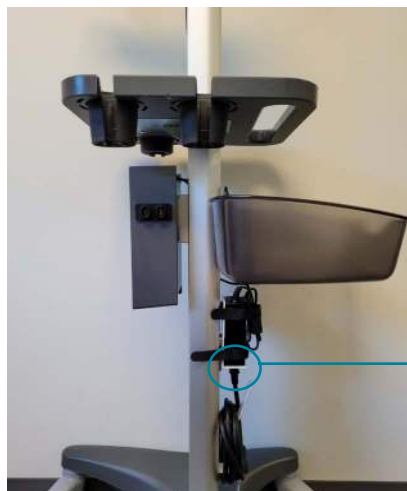
Branchement du bloc d'alimentation et du câble du bloc d'alimentation secteur
