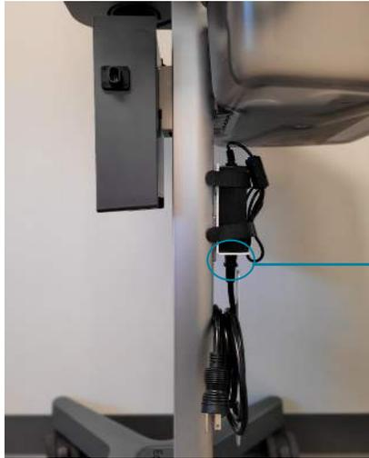
Conexão do bloco de alimentação e do cabo de alimentação
