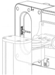
3. Segurando a parte superior do Kosmos Bridge, incline-o para frente e levante-o para removê-lo do suporte.
