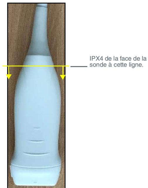
Fig 7.2 Protection de la sonde linéaire contre l'eau
