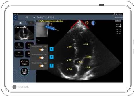
No fluxo de trabalho FE assistido por IA, você pode ativar o Trio\* para obter assistência na aquisição das visualizações A4C e A2C necessárias para o cálculo de FE.
