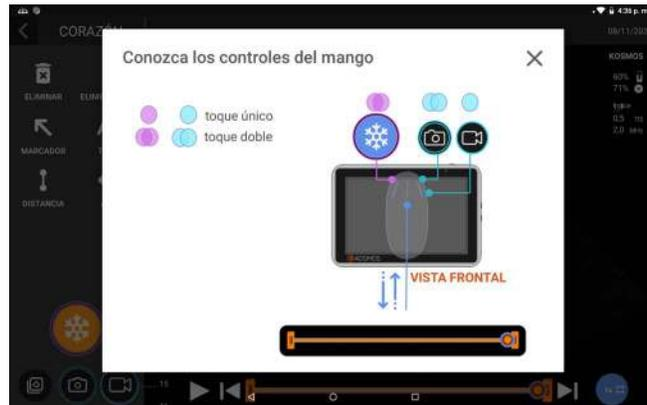
De manera similar, en la pantalla de revisión de películas, puede utilizar los controles del mango para congelar/descongelar, guardar imágenes y guardar vídeos. Use el deslizador para mover la perilla de las películas entre los límites.
