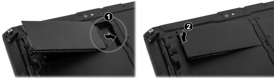
Figura 8. Cambiar las baterías de Kosmos Tablet G1
