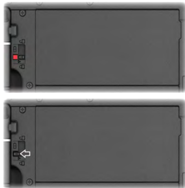
Figura 9. Fijar las baterías de Kosmos Tablet G1
