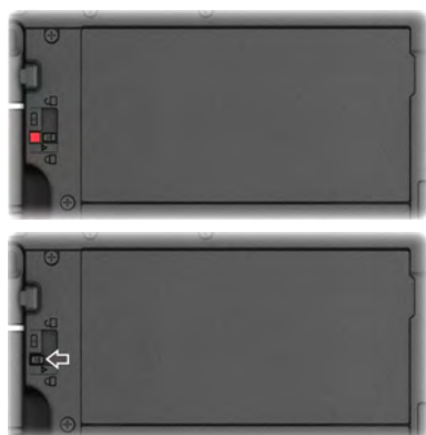
Figura 9. Fissaggio delle batterie di Kosmos Tablet G1
