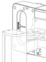
3. Al tiempo que sujeta la parte superior de Bridge, inclínelo hacia delante y levántelo para retirarlo del soporte.
