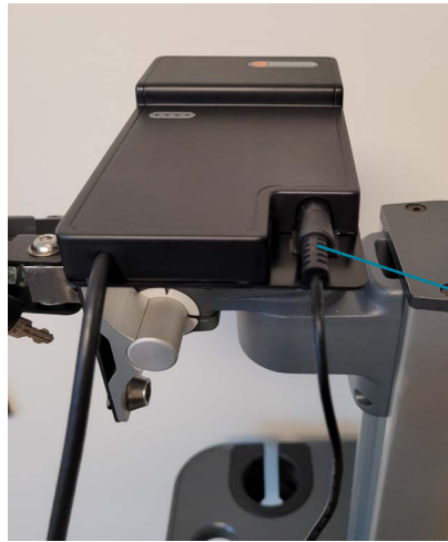
Voedingskabel van de Power Pack aangesloten op oplaadpoort van de Power Pack
