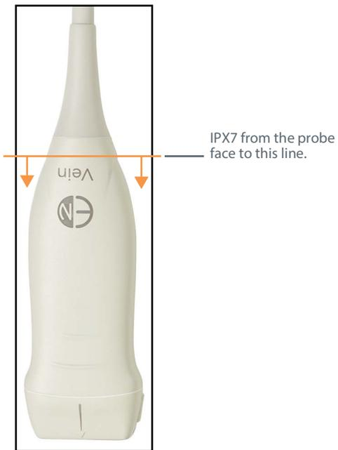
**FIGURE 48. Water protection for EchoNous Vein probe**
